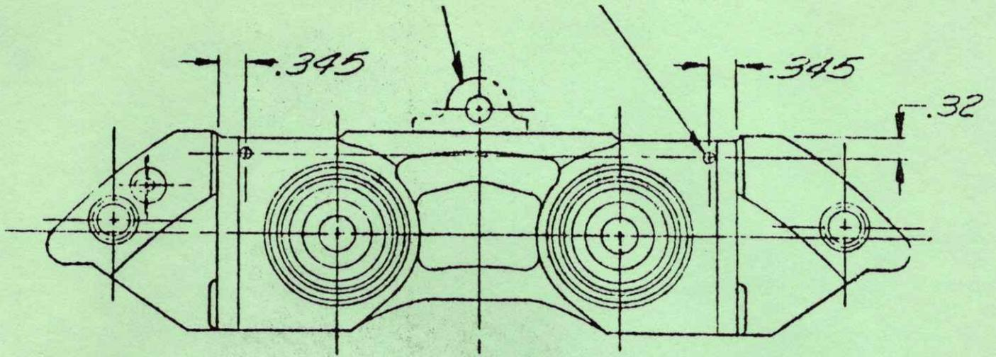
REWORK CALIPER AS SHOWN
